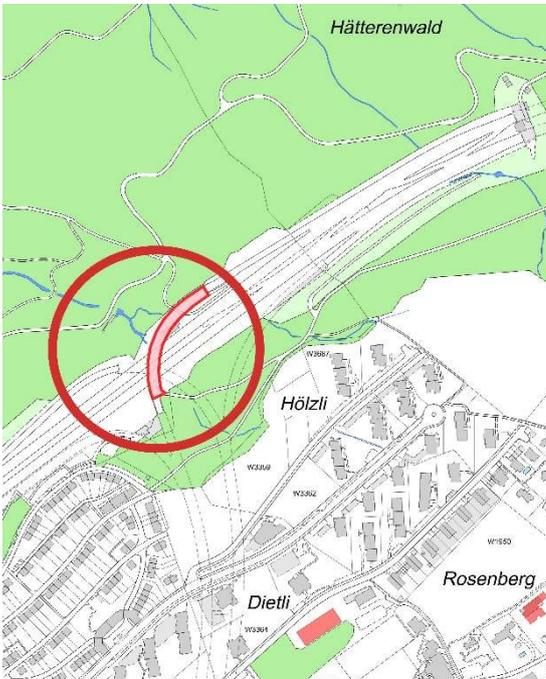
Das Bundesamt für Strassen ASTRA saniert im Rahmen des Projekts „Instandsetzung der Stadtautobahn St. Gallen“ die Brücke der Ausfahrt Kreuzbleiche in Fahrtrichtung Zürich sowie den parallel verlaufenden Gehweg. Die Arbeiten werden voraussichtlich Ende März beginnen und dauern bis Ende Juli / Anfang August 2025. Dabei werden unter anderem der Belag und die Abdichtungen ersetzt sowie die Fahrbahnübergänge erneuert.
