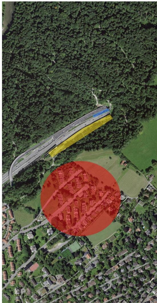
Gelb: Abbrucharbeiten und Anker-Bohrungen an der Stützmauer
